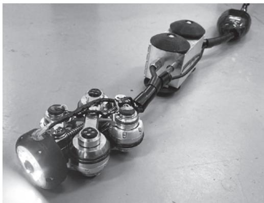
写真-2 並列弾性原点復帰機構を有する緊急時回収可能なロボット「Xbot-1.1」
